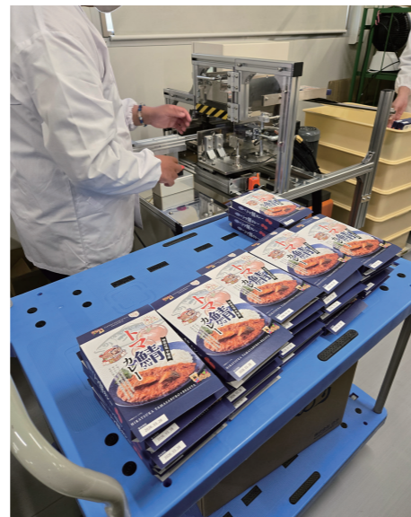
■自動機による封緘作業
